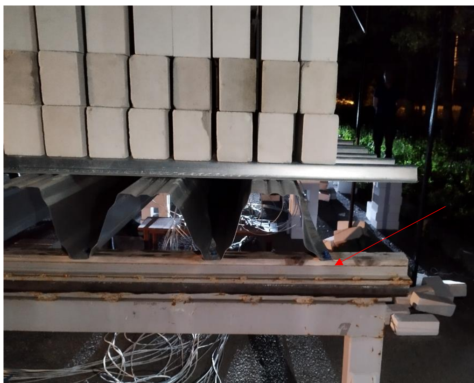
Рис. 4 – Потеря несущей способности профилированного настила Н153-840-1,0 на 3-м этапе загрузки (3 ряда кирпича – 816 шт – 4240 кг).
