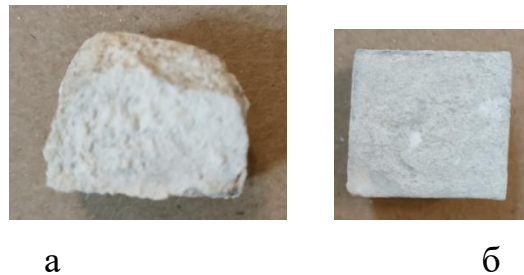
Рис. 1. Изменения внешнего вида бетона при воздействии бактерий: а – цементный камень, выдержанный в водном растворе кислот, б – цементный камень, выдержанный в дистиллированной воде
